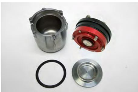
4. ➤ Falls der Deckel (9) sich an der Einheit befindet, diesen mit der Hand lösen und zur Seite legen. In der Regel bleibt der Deckel auf dem Becher (10) liegen.
