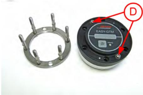
5. Die beiden Schrauben (D) des Batteriefaches mit dem Sechskant-Winkelschraubendreher 2.5mm (6) lösen.
