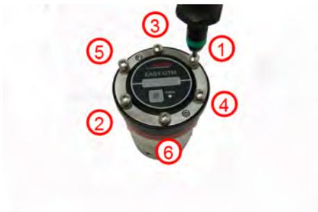
4. ➤ Innensechskantschrauben über Kreuz mit einem Drehmomentschlüssel (1) so lange anziehen, bis er ausrastet! Zur Sicherheit, nachdem alle Schrauben angezogen sind, nochmal nachdrehen. Wenn alle Schrauben wie beschrieben mit dem Drehmomentschlüssel angezogen sind, sind diese gegen Lösen während der Mahlung gesichert.
