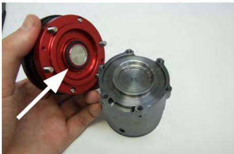
3. ➤ Sender mit Dichtung aufsetzen!
