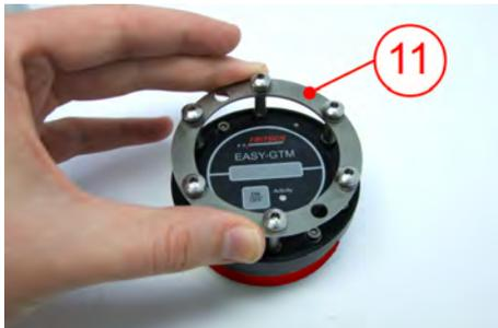
Verschlussring (11) inkl. Schrauben von der Mess- / Sendeeinheit abnehmen und komplett von Schmutz befreien.
