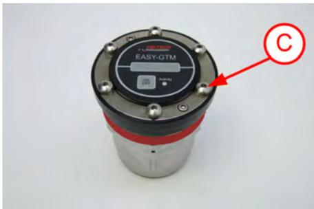
2. ➤ Dann die sechs Innensechskantschrauben (C), die zum Verschließen des Systems dienen, mit dem Sechskant-Schraubendreher (7) lösen. Der Verschlussring (11) mit den 6 Innensechskantschrauben kann nun abgenommen werden. (siehe ☞ „Reinigen des EASY GTM-Systems“ auf Seite 23)
