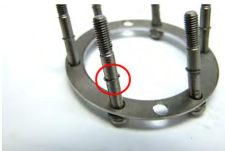
Die Schrauben sind mit einem Sprengring versehen, welcher verhindert, dass diese aus dem Verschlussring (11) herausfallen. Auf Sitz der Sprengringe achten! (siehe Bild!)
