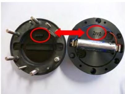
8. Beim Schließen des Batteriefachs auf die richtige Position der Steckkontakte achten!
